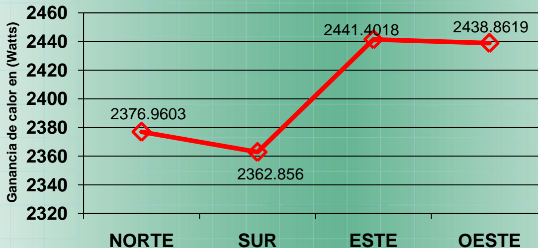
GANANCIA DE CALOR TOTAL EN LA VIVIENDA DE INTERÉS SOCIAL EN LA CIUDAD DE CHILPANCINGO, EN ORIENTACIONES PRINCIPALES
